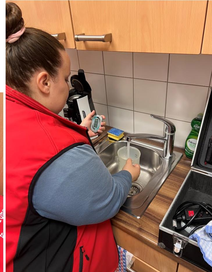
... und Wasserdurchfluss Messung
